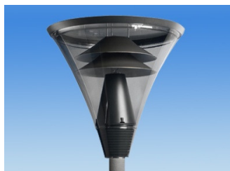
URBAN Vertical 20W-os, E27 fejű kompakt fénycsőhöz, IP66, Ø60 oszlopcsúcsra szerelhető, Ø565 x 560mm
