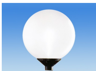
SFERA 400/B max.100W / E27 fény- forráshoz, Ø400mm opál burával, Ø60 oszlopcsúcsra szerelhető, IP55
