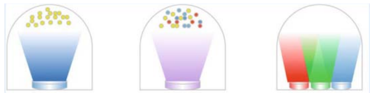
5.16 ábra – Fehér fény fényporos módszerrel (kék / UV LED-ek + fényporok), illetve RGB módszerrel (vörös + zöld + kék LED-ekkel) történő előállítása
