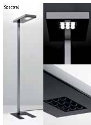
SOEL | LED-modul Állólámpa, ezüstsínű, matt alumínium csővel; a fej alsó részén erősen tükröző, fekete akril panellel; akrilból készült nagy pontosságú optikával az ipari szabványoknak megfelelő optikai szabályozáshoz és káprázás-csökkentéshez; az indirekt fény opcionális kapcsolhatósága, kapacitív érintőpanel, különállóan kapcsolható és szabályozható direkt/indirekt komponenssel
