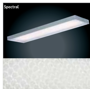
STORA | LED-modul Mennyezetre vagy függesztve szerelhető lámpatest mikrop prizmás PMMA panellel. A LED-ek közvetlenül rá nézve köröknek látszanak. A sarkok a különleges alumíniumkonstrukciónak köszönhetően fényzáróak. A hosszanti nyílásokon át indirekt fény is keletkezik.
