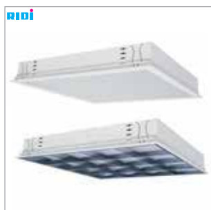
EBRE-LED | LED-modul Négyzetes, 625mm x 625mm-es álmennyezeti kivágásokba egyedileg besüllyeszthető lámpatest, acéllemez házzal Optika: ...MPS süllyesztett mikrop prizmás lemez PMMA-ból káprázásmentes direkt fényhez ...QSM parabolaszter nagy tisztaságú, eloxált, matt alumíniumból négyzetesen felosztott rasztercellákkal, a rasztereken szatírozott PMMA műanyag lapokkal
