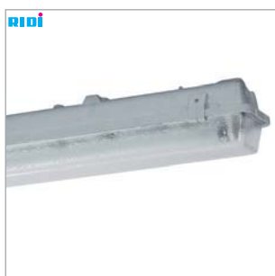
PFAG-H | LED R-TUBE Nedves helyiségekhez alkalmas mennyezetre szerelhető, IP65 védetségű lámpatest; Háza: üvegszállal megerősített szürke poliészter fehérre festett acéllemezéből készült beépített reflektorokkal; Bura: belső gyöngyszerkezetű, UV-álló PMMA, elveszthetetlen burarögzítéssel
