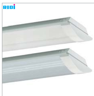
WL-H | LED R-TUBE IP40 védetségű burás lámpatest különböző felszerelési lehetőséggel: mennyezetbe félig besüllyesztve, felületre, csöves vagy kötéllel történő függesztéssel Optika: ...O opál bura UV-álló, belső hosszanti prizmas kialakítású PMMA-ból ...P erősen átlátszó, UV-álló, belső hosszanti prizmas kialakítású PMMA-ból készült bura
