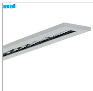
F-LINE-H 1.. | LED R-TUBE Mennyezetre vagy függesztve szerelhető, igen lapos, egyenes, L-, T-vagy kör alakban összeállítható lámpatest Optika: ...SM parabolatükör-raszter ezüstsínű bevonattal ellátott, nagytisztaságú, eloxált, matt alumíniumból
