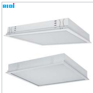
EBRE-LED | LED-Modul Négyzetes, 625mm x 625mm-es álmennyezeti kivágásba egyedileg besüllyeszthető, IP20/IP40 vagy IP54 védetségű lámpatest, acéllemez házzal Optika: ...OS - UV-álló PMMA-ból készült, opál műanyag lappal lefedve
