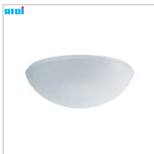
RK-LED | LED-Modul Kerek, burás lámpatest, UV-álló PMMA-ból készült, opál, félgömb alakú műanyag burával Átmérője: 260 vagy 330 mm Beépített nagyfrekvenciás (radar) mozgásérzékelővel szerelve is kapható
