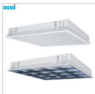
EBRE-LED | LED-Modul Négyzetes, 625mm x 625mm-es álmennyezeti kivágásokba egyedileg besüllyeszthető lámpatest, acéllemezről készült házzal. Optika: ...MPS mikroprizmás lemez PMMA-ból káprázásmentes direkt fénykomponenshez ...QSM parabolaszter nagytisztaságú, eloxált, matt alumíniumból négyzetesen felosztott rasztercellákkal, a rasztereken szatírozott PMMA műanyag lapokkal
