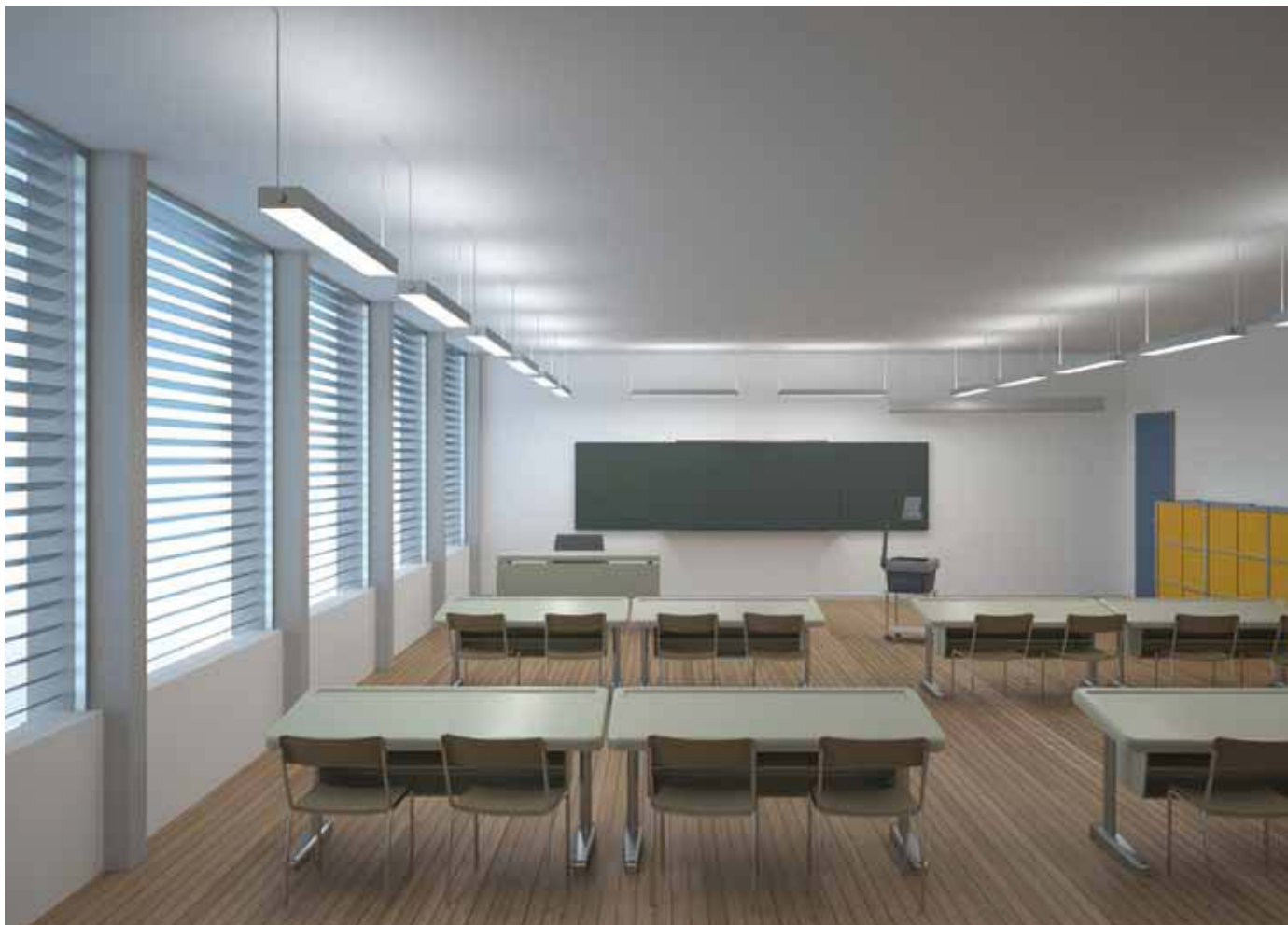
A lámpatest-sorok egyedi kapcsolhatósága (napfény-függő szabályozás)
