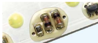
Az elektromos komponenseket a nedvesség ellen védő festékreteg
