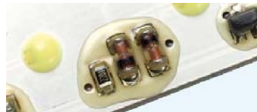
Az elektromos komponenseket a nedvesség ellen védő festékreteg
