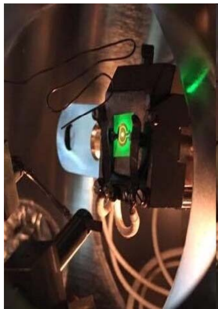
Elektromosan gerjesztett zöld LED a Santa Barbarai Kaliforniai Egyetem ultranagyvákuumú elektron-emissziós spektroszkóp-kamrájában. Az eszköz konstrukciója lehetővé teszi az elektronoknak a LED felületről történő emisszióját.
