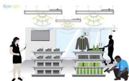
2.11 ábra Látható fénnel történő kommunikáció (VLC) + kis energiájú Bluetooth (BLE) kapcsolja a lámpatesteket a beltéri jeladókhöz (Forrás: Dan Ryan, ByteLight, SSL R&D Workshop, San Francisco, CA, 2015. január [18])
