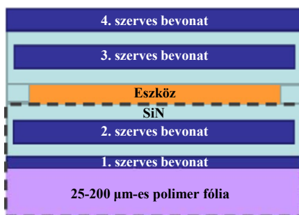
6.21 ábra – Többrétegű gát-bevonat a nedvesség- és az oxigénrészecskék behatolásának megakadályozására (Forrás: Pim Groen, Holst Centre, DOE SSL R&D Workshop, San Francisco, CA, 2015. jan. [101])
