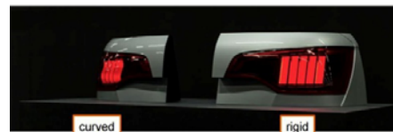
6.19 ábra – Az Audi Q7 hátsó helyzetjelző lámpája („ívelt”, rugalmas és „merev” változat) (Forrás: Thilo Reusch, OSRAM LED, DOE R&D Workshop, Raleigh, Észak-Karolina, 2016. febr. [103])
