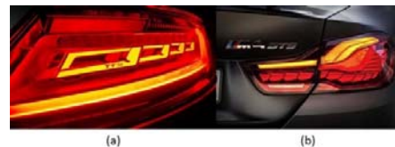
6.18 ábra – OLED-es hátsó helyzetjelző lámpák (a) Audi TT RS 2016 (b) BMW M4 Concept Iconic Lights (Forrás: (a) http://www.beelighting.co.uk/news/ (b) BMW Blog, 2015 [156])
