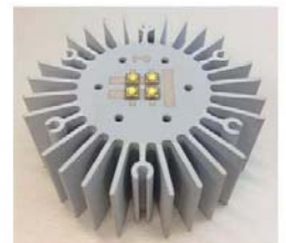
L2+: beépített LED-ek+hűtőborda
