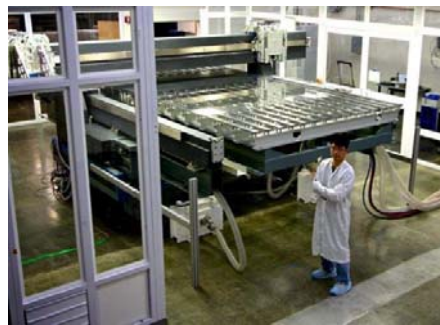
6.27 ábra – Tintasugaras nyomtató a nyolcadik-generációs hordozók számára (Forrás: A Kateeva végre bemutatja Yieldjet OLED TV-jéhez készült tintasugaras nyomtatórendszerét [193])
